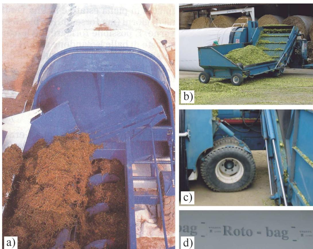
Figura 43 - Insilamento in contenitore tubolare: a) veduta della pressa insilatrice (da: Ciotti, 1992); b) tramoggia per l'alimentazione; c) dispositivo per il frenaggio; d) particolare del contenitore in PE: la distanza fra i trattini sovrapposti indica il grado di riempimento del contenitore.
