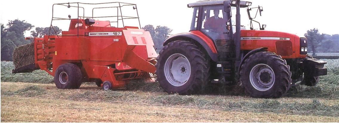
Figura 25 - Confezionamento delle balle parallelepipedo a partire dal fieno in andane.
