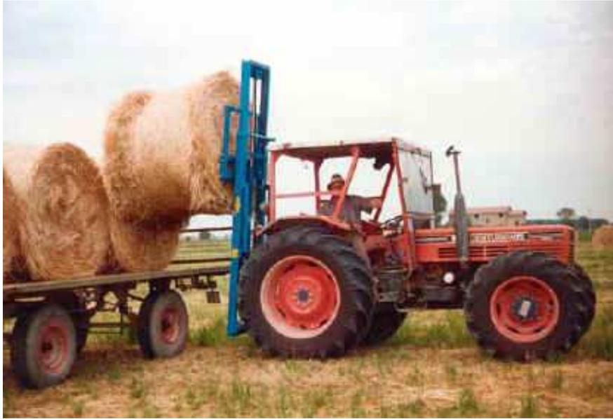
Figura 23 - Movimentazione meccanizzata delle rotoballe.
